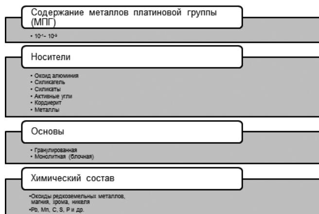
**Рис. 2.** Характеристика катализаторов как объекта аналитического контроля
