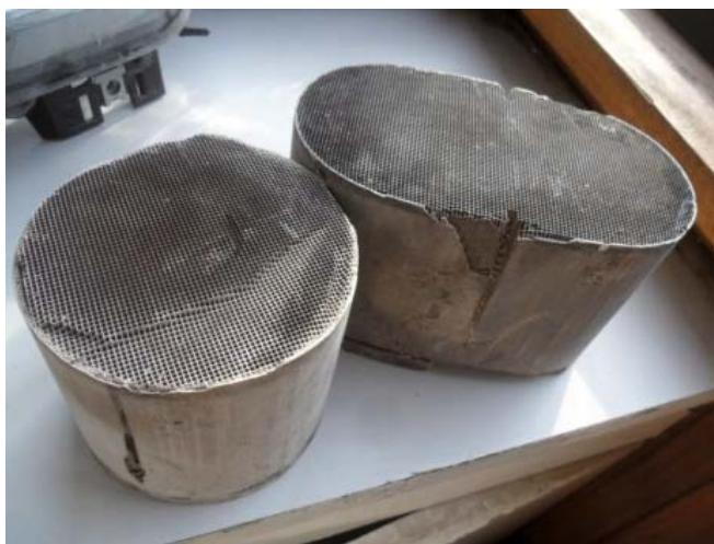
Рис. 3. Блок отработанного автокатализатора
