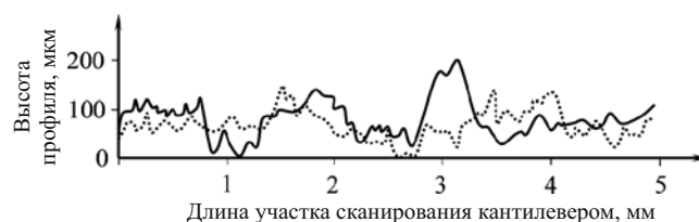
Рис. 2. Профилограммы внутренней (сплошная линия) и наружной (пунктир) поверхностей цилиндрической оболочки
