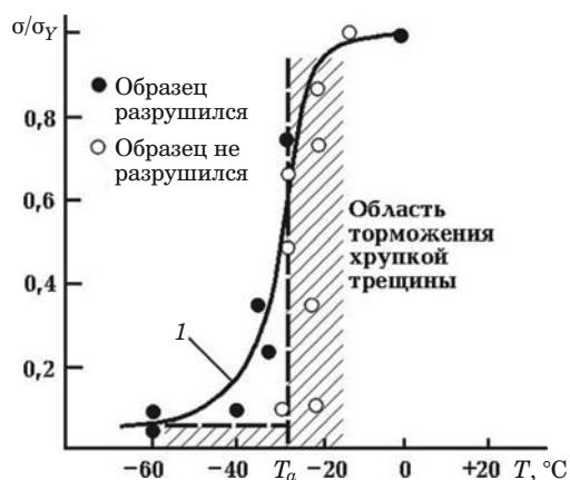
Рис. 1. Тензотемпературная кривая остановки трещины и ее условное представление (заштрихованная область) для образца из стали марки D40 толщиной 20 мм [7]
