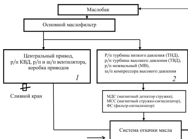
Рис. 2. Структурная схема подачи смазочного масла к основным агрегатам двигателя
